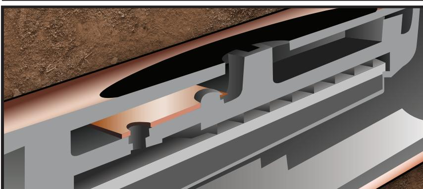
Эмиттеры серии XFS защищены от проникновения корней при помощи ожидающей получения патента технологии Copper Shield компании Rain Bird, которая позволяет создать систему, не требующую технического обслуживания или использования химреагентов для предотвращения проникновения корней. Медная окраска шланга подтверждает наличие медной пластинки внутри трубопровода.
